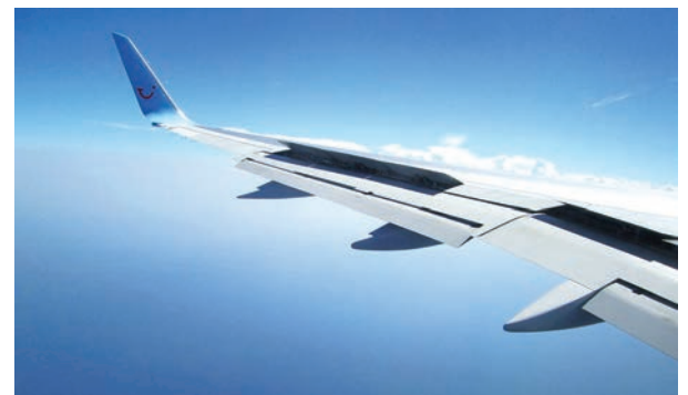
Spoiler im Einsatz bei einer Verkehrsmaschine zur Reduzierung der Geschwindigkeit und Erhöhung der Sinkrate. / Spoiler in use on a commercial aircraft to reduce speed and increase sink rate.
