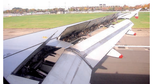
Automatisch fahren die Spoiler bei der Airbus A320 aus, sobald die Maschine auf der Bahn aufgesetzt hat und der Pilot die Funktion vorgewählt hat. / Spoilers automatically deployed on the Airbus A320 as soon as the aircraft has touched down on the runway and the pilot has preselected the function.
